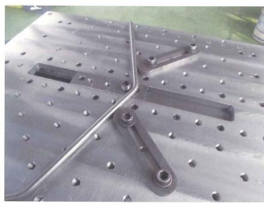
自在Vダイ (標準付属品) 16×16までの角、平、丸棒曲げ
