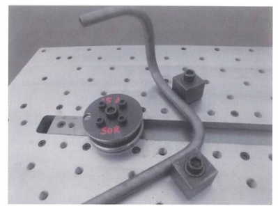
パイプ等のキズなし曲げダイ (標準付属品) (センターフォーマーはオプション)
